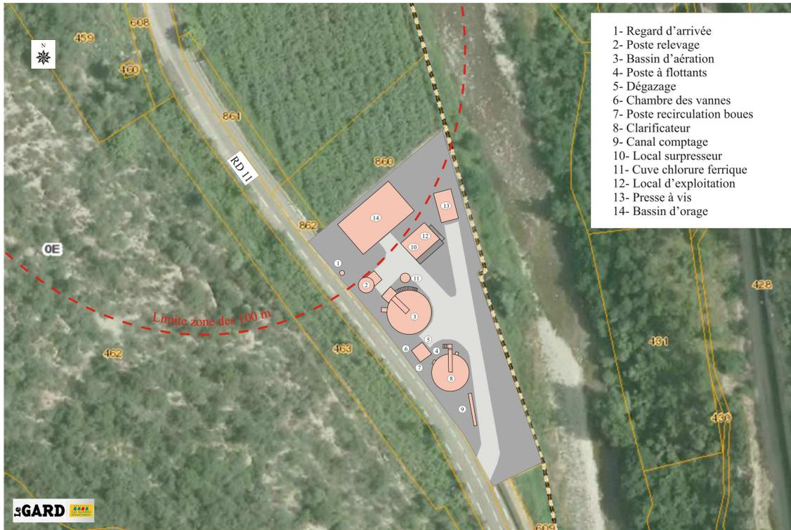
Une station d'épuration de type boues activées dimensionnée pour 1500 EH avec traitement des boues par presse à vis peut être implantée sur ce site, comme l'indique le schéma ci-dessus.
