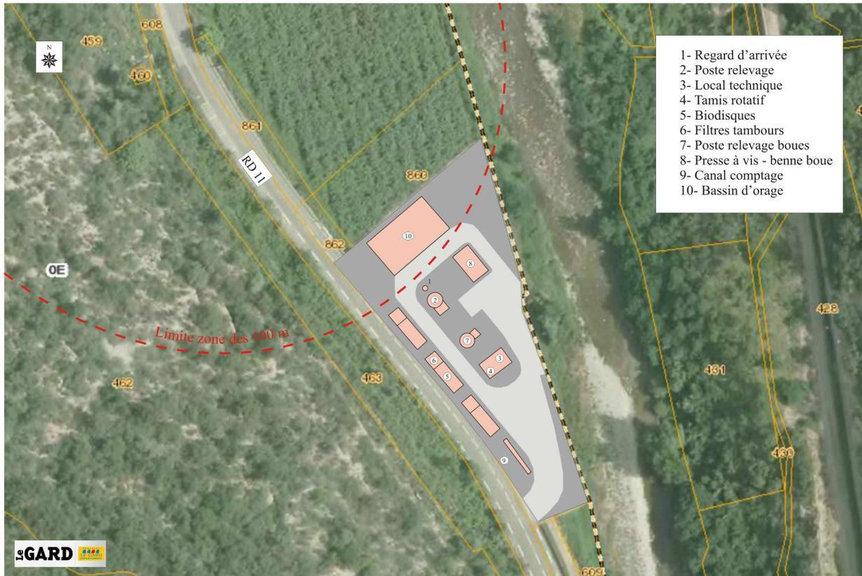
Vue aérienne d'une station d'épuration à biodisques et traitement des boues par presse à vis
